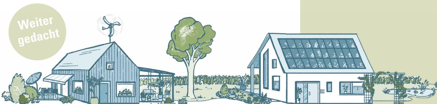
Ein Passivhaus benötigt kaum Energie für das Heizen im Winter und das Kühlen im Sommer. Eine Solaranlage auf dem Dach übernimmt die restliche Energieversorgung und spart  $\text{CO}_2$ . Intelligent ausgerichtete Fenster und ein Wärmespeicher aus Lehm oder Stein sorgen auch im Gebäude ganzjährig für ein gutes Klima. In Massivholzwänden ist  $\text{CO}_2$  sogar gespeichert.
