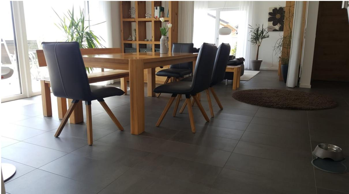
Abb. 12: Fliesen als Bodenbelag ermöglichen einen guten Wärmeaustausch und können direkt ohne Trittschall-dämmung auf der geglätteten Bodenplatte verlegt werden."
