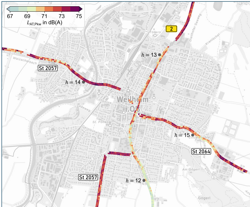
Abb. 21: Median des auf eine Geschwindigkeit von 50 km/h umgerechneten äquivalenten Fahrzeuggeräuschpegel für Pkw L_{AT,PKW} für 20 m lange Segmente der kartierten Straßen in Weilheim. Die Orte h = 12 bis 15, an denen SPB-Messungen stattfanden, sind miteingezeichnet. Die Emission auf der Referenzoberfläche (MA-NG) beträgt 74,8 dB(A).
