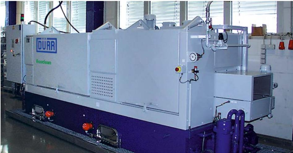
Abb. 3: Durchlaufanlage für Kleinteile
