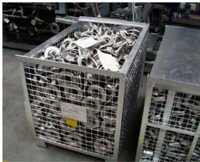
Abb. 13: Reinigung als Schüttgut (Quelle: Draht Schnee, Dürr Ecoclean)
