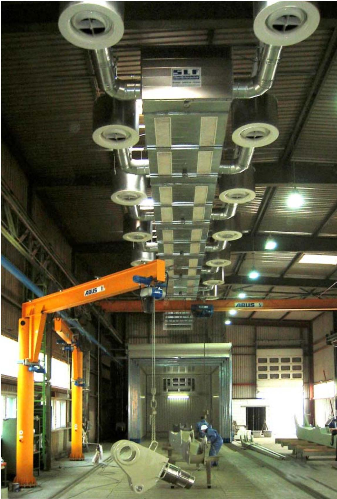
**Freiflächenlackieranlage mit Teleskoptrockner**
