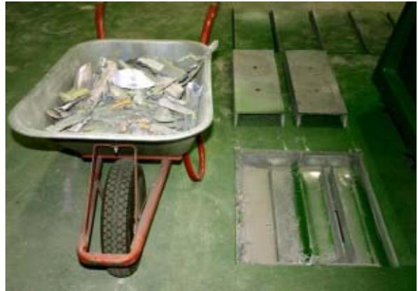
**Lackabfälle aus dem Prallabscheider, die die Filtermatte nicht belasten**
