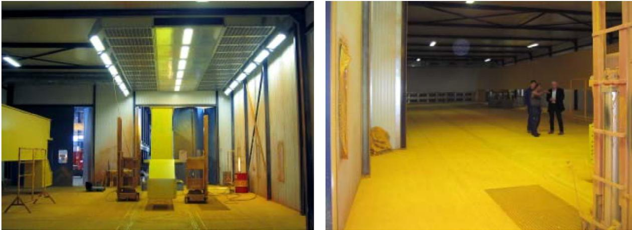
Als Absaugung werden hier Absaugkanäle im Boden oder eine Spritzwand eingesetzt, die jedoch nur eine Absaugwirkung von max. 1 m haben. Der Zwischenraum in dem der Werker arbeitet bleibt gänzlich unbelüftet mit u. U. hohem MAK Werten und Lösemittelkonzentrationen.
