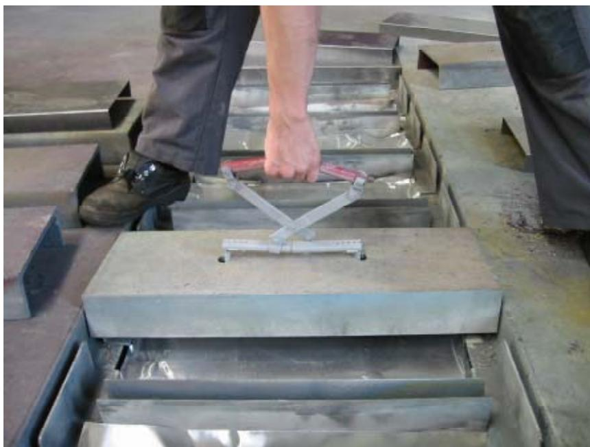
**Aufnahme der Schwerlast-Prallabscheider mit dem Gripper**
