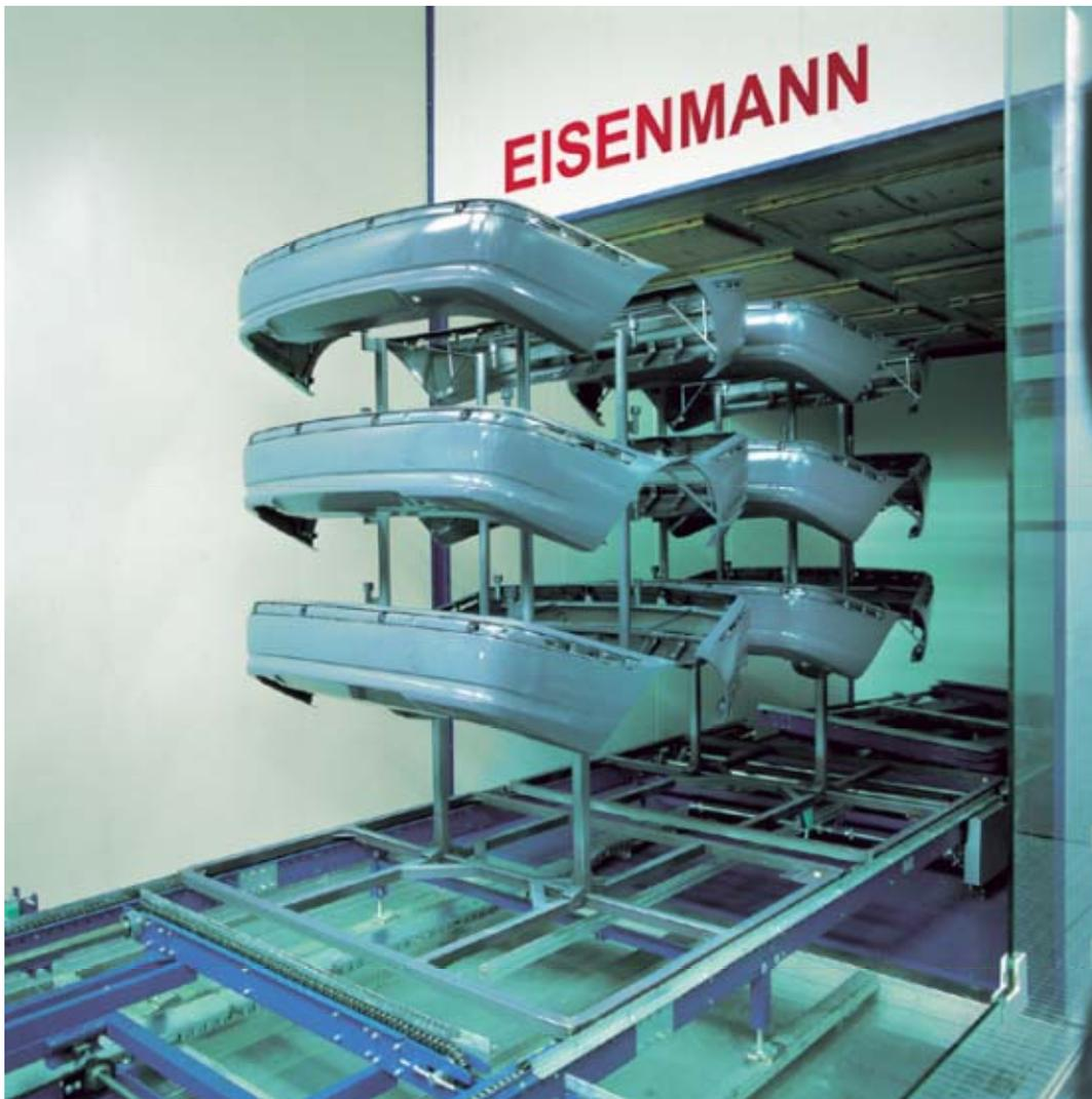
Abb. 1: Serienlackierung anspruchsvoller Pkw-Stoßfänger (Skidfördersystem)
