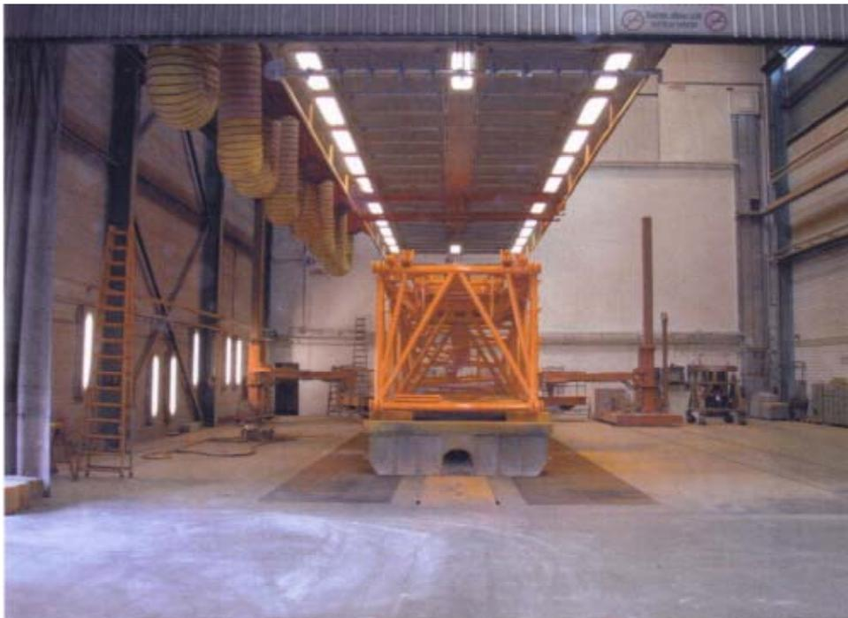
In vielen Fällen wird daher in der offenen Werkhalle lackiert, mit oder ohne Absaugung. Hierbei wird, wenn überhaupt, Zuluft durch einen unter der Hallendecke hängenden Kanal in die Halle eingeblasen. Die erwärmte Zuluft erreicht jedoch aufgrund des zu geringen Impulses und bedingt durch die Thermik in keinem Falle die Absaugkanäle, um die Schadstoffe zu entfernen. Diese verteilen sich und bleiben, **wie das nachstehende Bild zeigt**, im gesamten Raum am Boden liegen.
