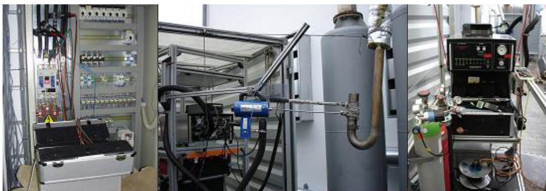
Abb. 11: Messgeräte für Leistung und Abgaszusammensetzung im Praxiseinsatz
