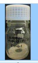
Filter nach Überführung in Extraktionsgefäß
