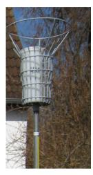
Abb. 11: Die Abbildung zeigt ein sogenanntes Bergerhoff-Sammelgefäß zum Sammeln des Staubniederschlages
