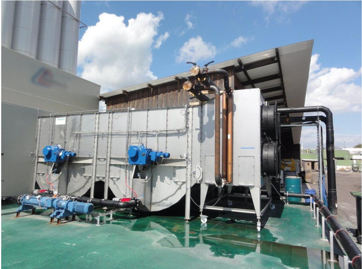
Abb. 14: Beispielanlage eines Schaufelradrockners mit zwei Wannen nach *Einkammerer*
