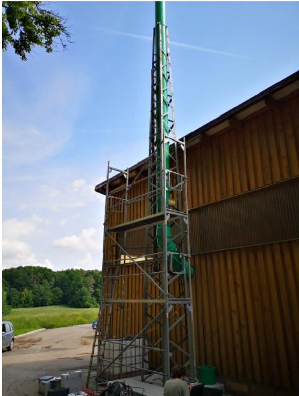
Abb. 38: Reingasmessstelle Anlage C nach Betreiber Anlage C (2021)
