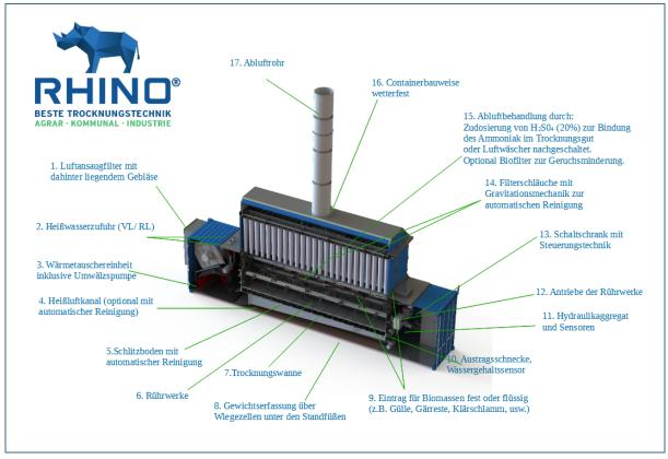
Abb. 19: Schnittbild eines Rührwerkstrockners mit Beschriftung der einzelnen Komponenten nach RHS Maschinen- u. Anlagenbau GmbH
