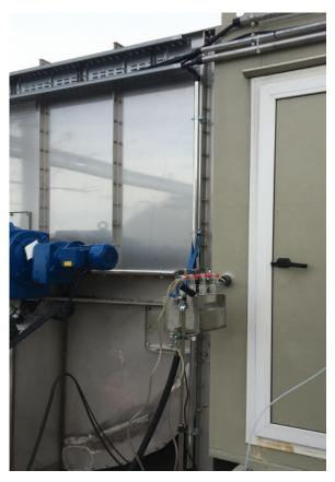
Abb. 25: Rohgasmessstelle Anlage A nach Betreiber Anlage A (2019)
