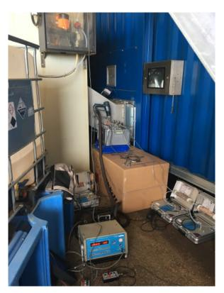
Abb. 33: Rohgasmessstelle vor Wäscher Anlage B nach Betreiber Anlage B (2020)
