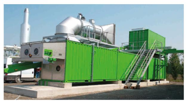
Abb. 31: Kombiniertes Trocknungsverfahren (direkt mit BHKW-Abgas und indirekt über Wärmetauscher) vergleichbar der Anlage B nach *NEW eco-tec Verfahrenstechnik GmbH*
