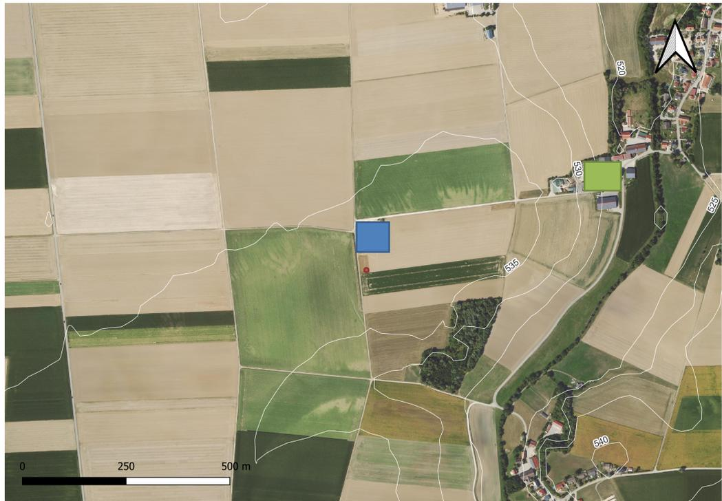
Abbildung 2. Standort des Außenklimastalls von M1 (blaue Markierung: Stallgebäude; roter Punkt: meteorologische Messstation) mit Einordnung von Störeinflüssen (grün: Biogasanlage/Fahrsilo), Karte: ©Geobasisdaten: Bayerische Vermessungsverwaltung – [www.geodaten.bayern.de](http://www.geodaten.bayern.de), Lizenz: CC BY 4.0, 2023 [20].
