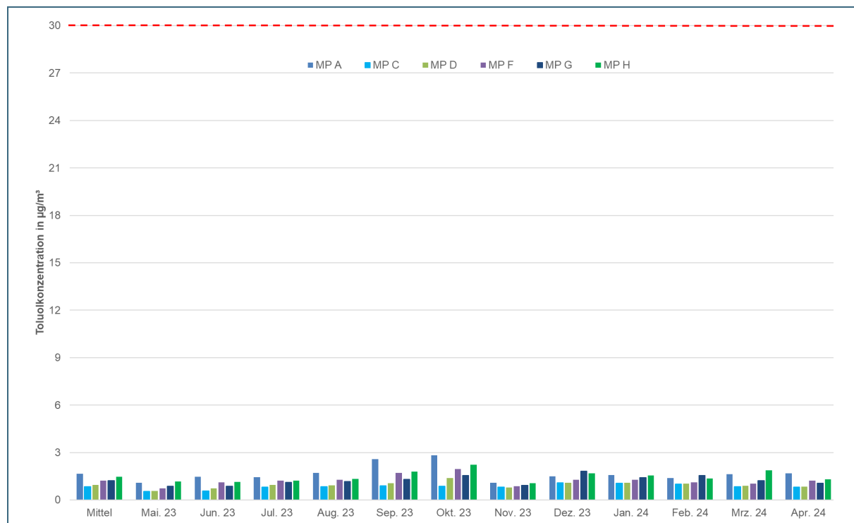
Abb. 30: Zeitlicher Verlauf der Monatsmittelwerte der Toluolkonzentration an den Messpunkten MP A, MP C, MP D, MP F, MP G und MP H im einjährigen Messzeitraum 28.04.2023 bis 02.05.2024 (Phase III). Der angegebene Zielwert der LAI (in rot gestrichelt) bezieht sich auf den Jahresmittelwert.
