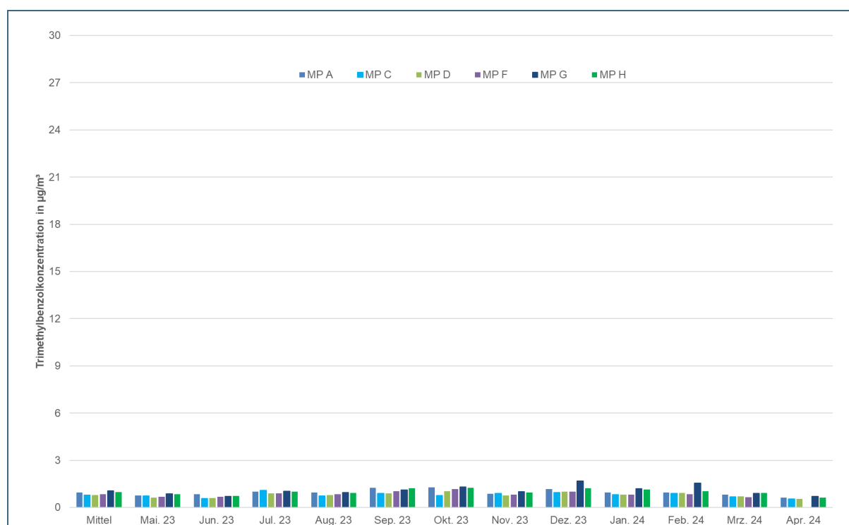
Abb. 36: Zeitlicher Verlauf der Monatsmittelwerte der Trimethylbenzolkonzentration an den Messpunkten MP A, MP C, MP D, MP F, MP G und MP H im einjährigen Messzeitraum 28.04.2023 bis 02.05.2024 (Phase III). Der Beurteilungswert von 1.000 µg/m 3 (Jahresmittelwert) ist aufgrund des geringen Immissionsniveaus nicht dargestellt.
