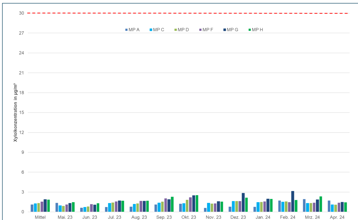
Abb. 32: Zeitlicher Verlauf der Monatsmittelwerte der XyloleKonzentration an den Messpunkten MP A, MP C, MP D, MP F, MP G und MP H im einjährigen Messzeitraum 28.04.2023 bis 02.05.2024 (Phase III). Der angegebene Zielwert der LAI (in rot gestrichelt) bezieht sich auf den Jahresmittelwert.
