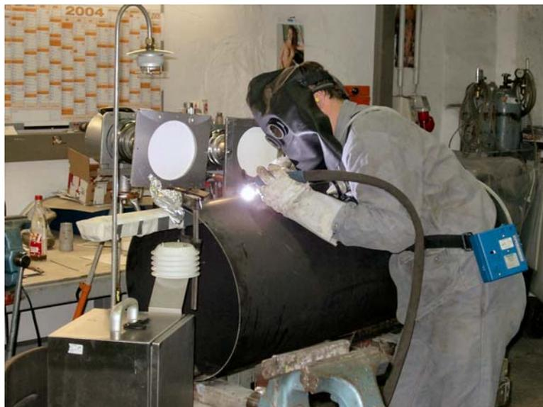
Abb. 16: Stationärer Staubsammler, Kleinprobensammler und personengetragener Probensammler im Einsatz
