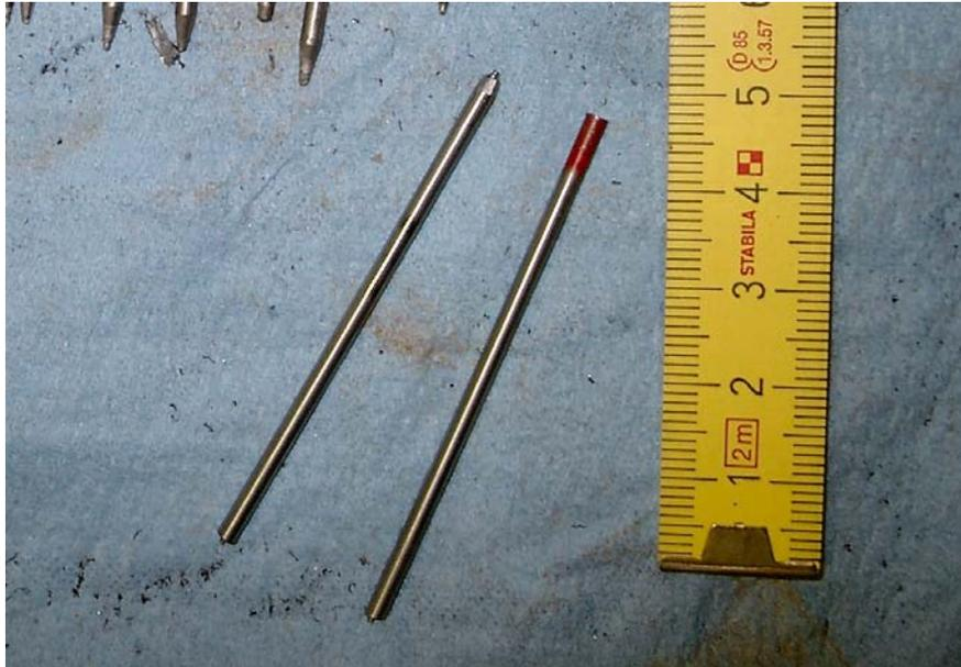
Abb. 14: Thorierte Wolframelektroden (rechts: WT20)
