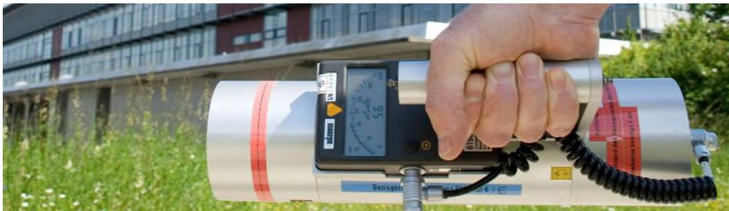
Radioaktive Strahlen kann man weder sehen noch riechen, nur mit einem Messgerät kommt man ihnen auf die Spur. Der hier angezeigte Wert von  $0,056 \mu\text{Sv/h}$  entspricht der natürlichen Strahlung.
