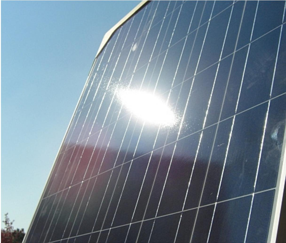
Reflex auf einem polykristallinen PV-Modul im Nahbereich
