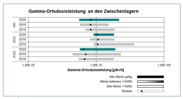
Abb. 11: Übersicht über die Wertebereiche der Gamma-Ortsdosisleistung (G-ODL) an den Brennelement-zwischenlagern gem. REI, Tabelle C1.1, Punkt 1.1 im Jahr 2020 im Vergleich zu den Vorjahren 2019 und 2018
