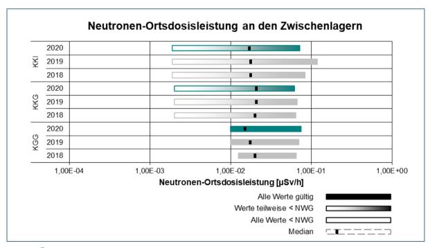
Abb. 12: Übersicht über die Wertebereiche der Neutronen-Ortsdosisleistung (N-ODL) an den Brennelement-zwischenlagern gem. REI, Tabelle C1.1, Punkt 1.3 im Jahr 2020 im Vergleich zu den Vorjahren 2019 und 2018
