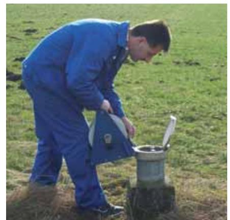
▲ Messung des Grundwasserstandes mit einem Lichtlot.
