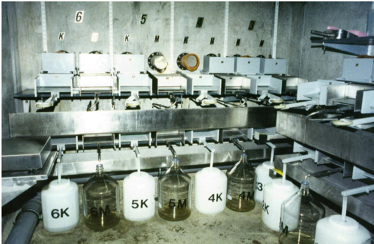
Abb. 27: Sickerwassersammelstation im Keller des Versorgungshäuschens
