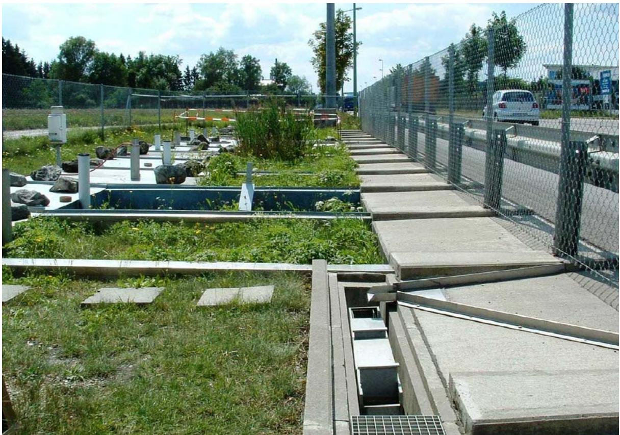
Abb. 26: Felder der Versuchsanlage, im Vordergrund Einlauf in den Leichtstoffabscheider Feld LSTA
