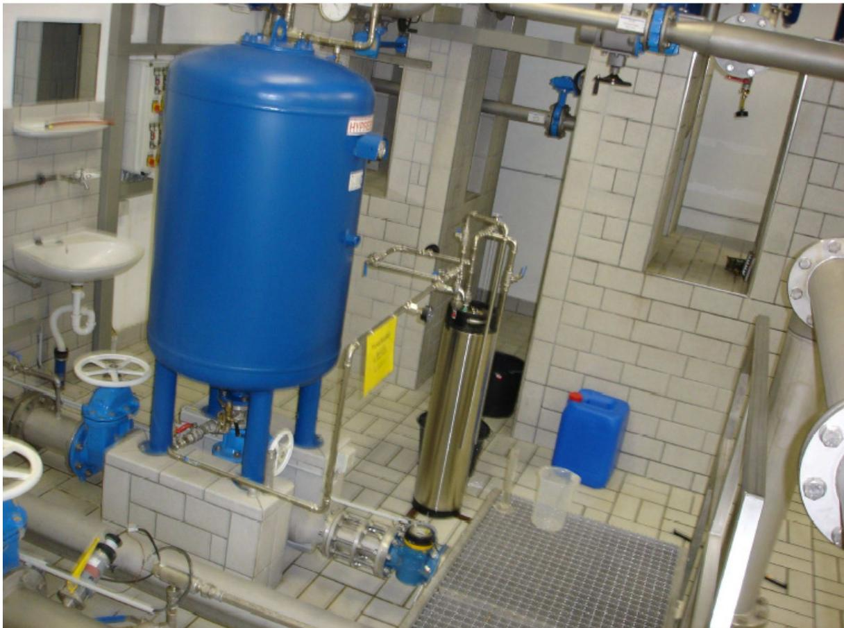
Abb. 20: Halbtechnische Versuchsapparatur aus Edelstahl zur Uran-Adsorption durch Ionenaustausch, angeschlossen an die Druckerhöhungsanlage des Wasserwerkes B
