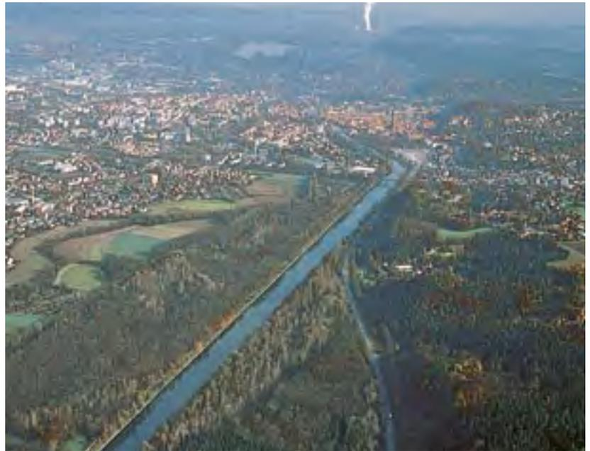
Abb. 45: Durch die Korrektion wurde die Mittlere Isar begradigt und zu einem strukturell stark verarmten Gerinne ausgebaut, wie hier vor Landshut.
