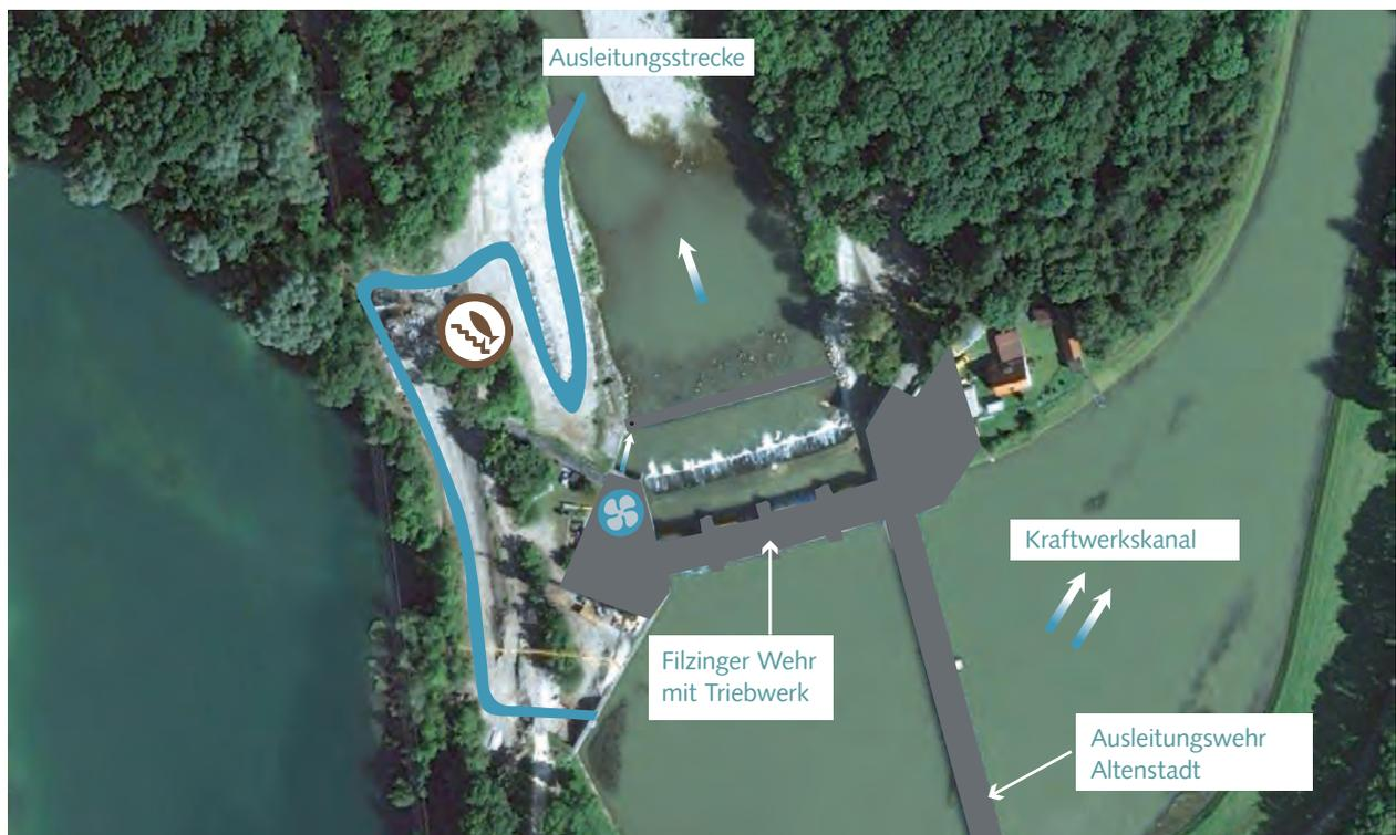
Übersicht Wehr, Kraftwerk und FAA von unterstrom (~ MQ):
