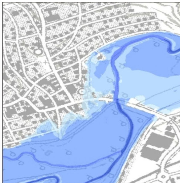
Realität und Modellierung: Luftbild eines hochwasserführenden Gewässers und der dazugehörige Ausschnitt einer Hochwassergefahrenkarte
