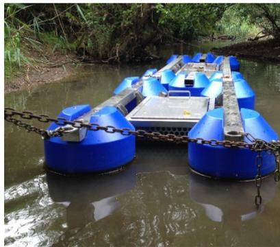
Abb. 9: Der Schwimmkäfig mit den Muscheln wird kontinuierlich vom Flusswasser durchströmt.
