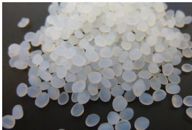
Abb. 1: Beispiel für primäres Mikroplastik: Pellets, die als Rohstoff in der Industrie eingesetzt werden
