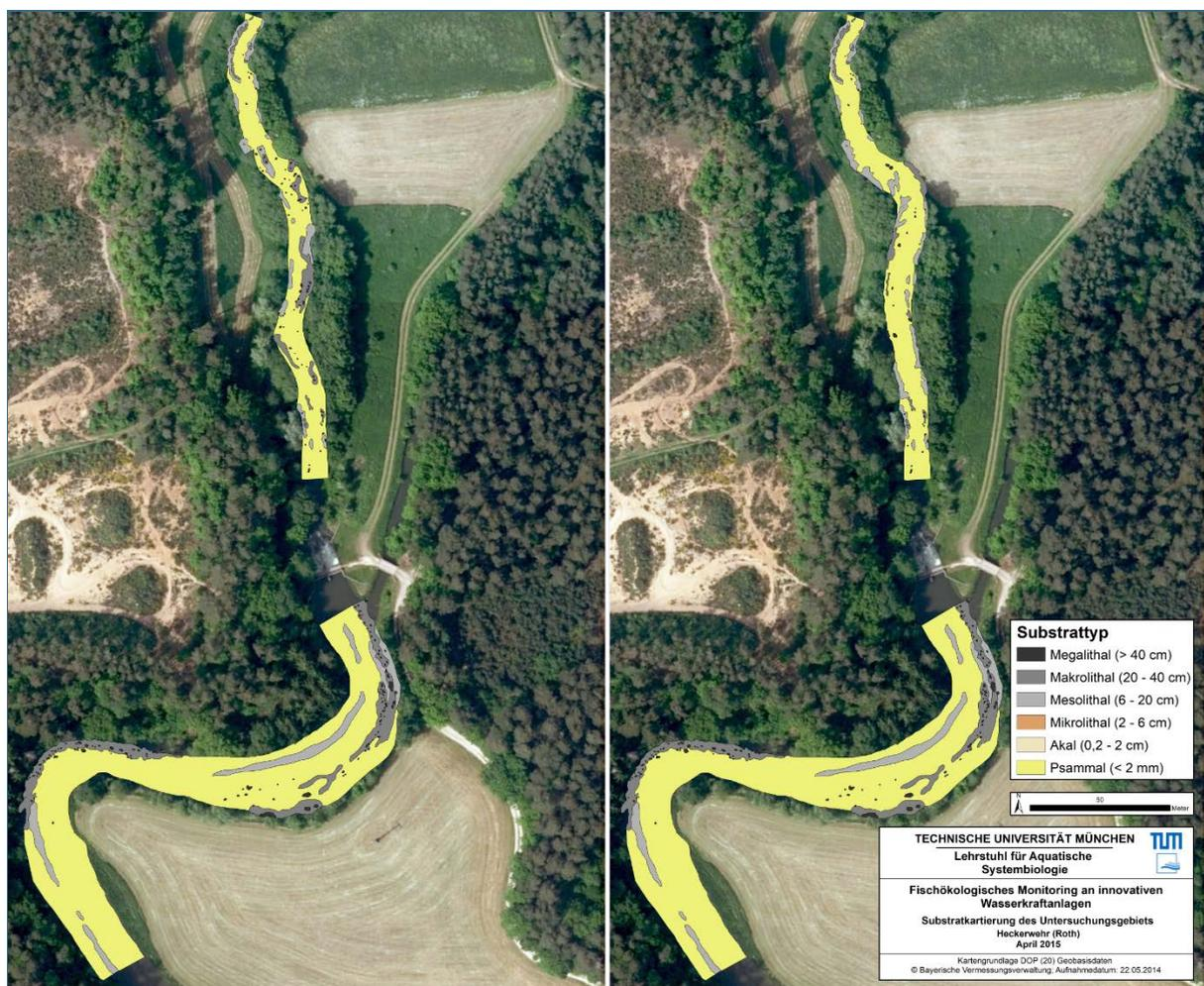
Abb. 8: Substratkartierung der Untersuchungsstrecken am Standort Heckerwehr an der Roth vor (links, August 2014) und nach (rechts, April 2015) dem Kraftwerksbau. Das hinterlegte Luftbild ist jeweils identisch und entstand vor dem Kraftwerksbau im Mai 2014
