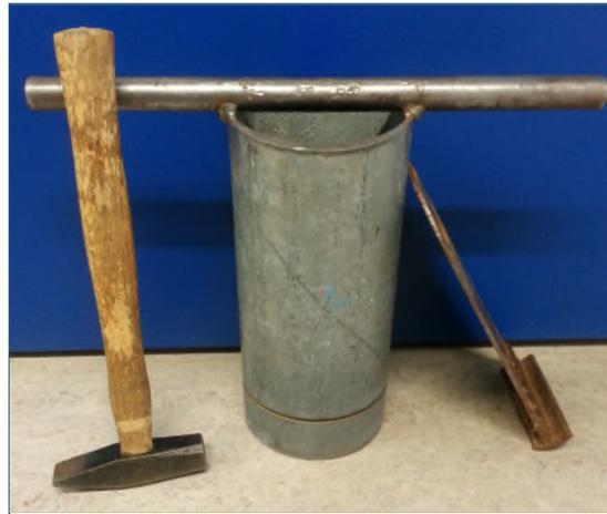
Abb. 8: Equipment für die Entnahme von Ufersediment
