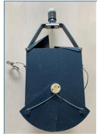
Abb. 9: Bodengreifer zur Entnahme von Grundsediment
