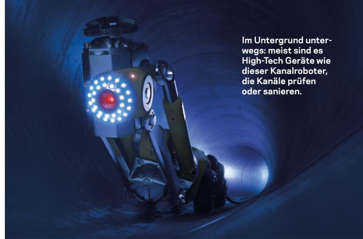
Im Untergrund unterwegs: meist sind es High-Tech Geräte wie dieser Kanalroboter, die Kanäle prüfen oder sanieren.
