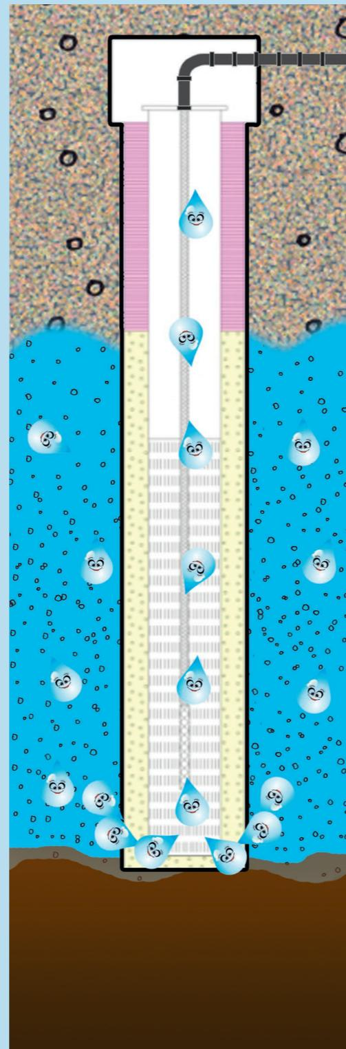
Hier siehst du einen Brunnen. Ein Brunnen ist ein Loch, das von der Erdoberfläche bis zum Grundwasser gebohrt wird. Es werden spezielle Rohre eingebaut, durch die das Grundwasser ins Innere der Rohre fließen kann. Dann wird eine Pumpe eingebaut. Über ein Steigrohr wird das Wasser nach oben gedrückt und in einem Vorratsbehälter gesammelt. Diesen nennt man Hochbehälter.
