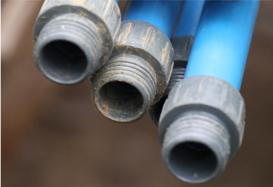
Abb. 8: Fotobeispiel zur Kategorie „Verschmutzungen“ – verschmutzte Steigrohre
