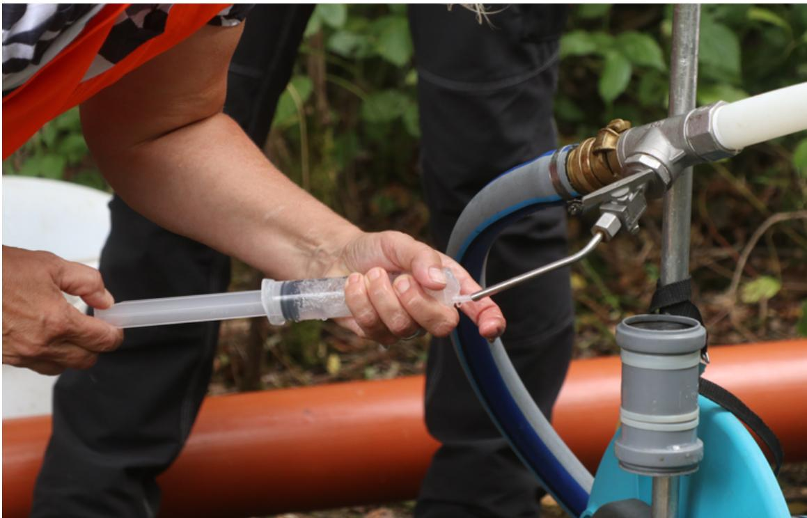
Abb. 11: Fotobeispiel „Fehlbedienungen, falsche Handhabung“ – Lufteintrag in Spritze
