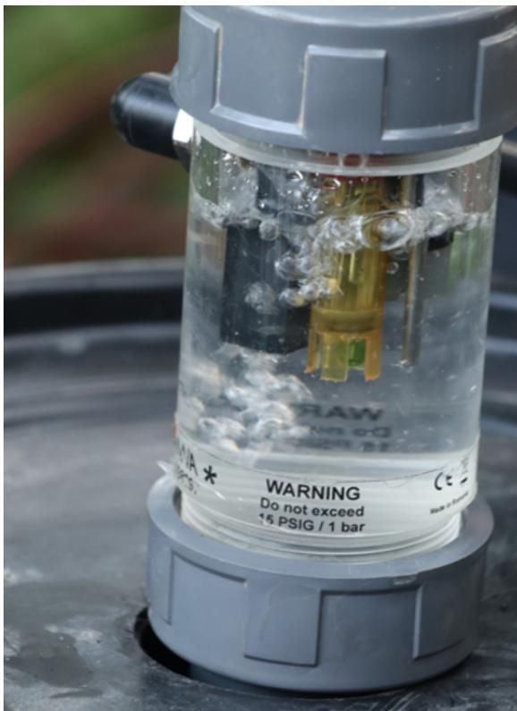
Abb. 13: Fotobeispiel „Technische Unzulänglichkeiten“ – Lufteintrag in Durchlaufzelle
