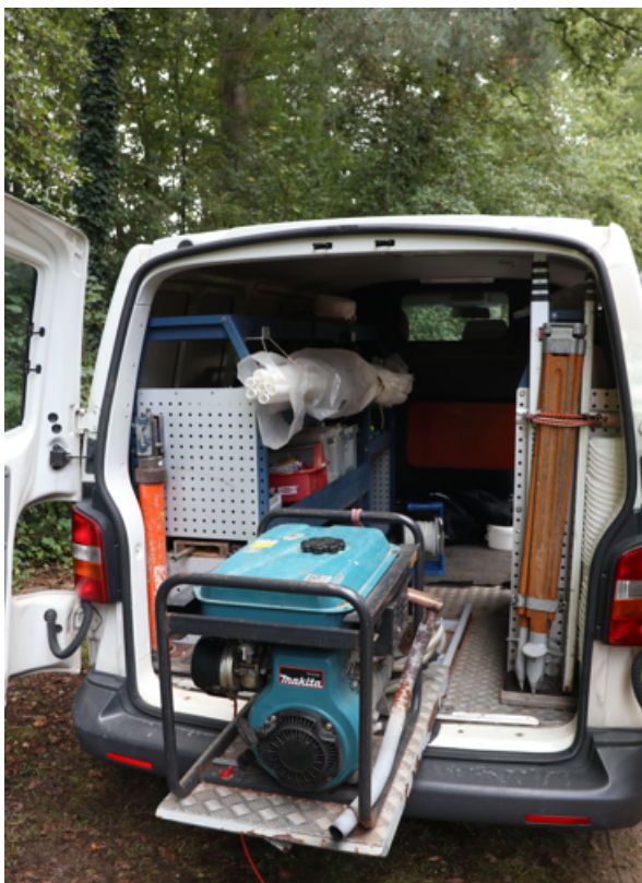
Abb. 9: Fotobeispiel zur Kategorie „Querkontaminationen“ – kraftstoffbetriebenes Stromaggregat zusammen mit Probenahmegeräten im KFZ-Laderaum
