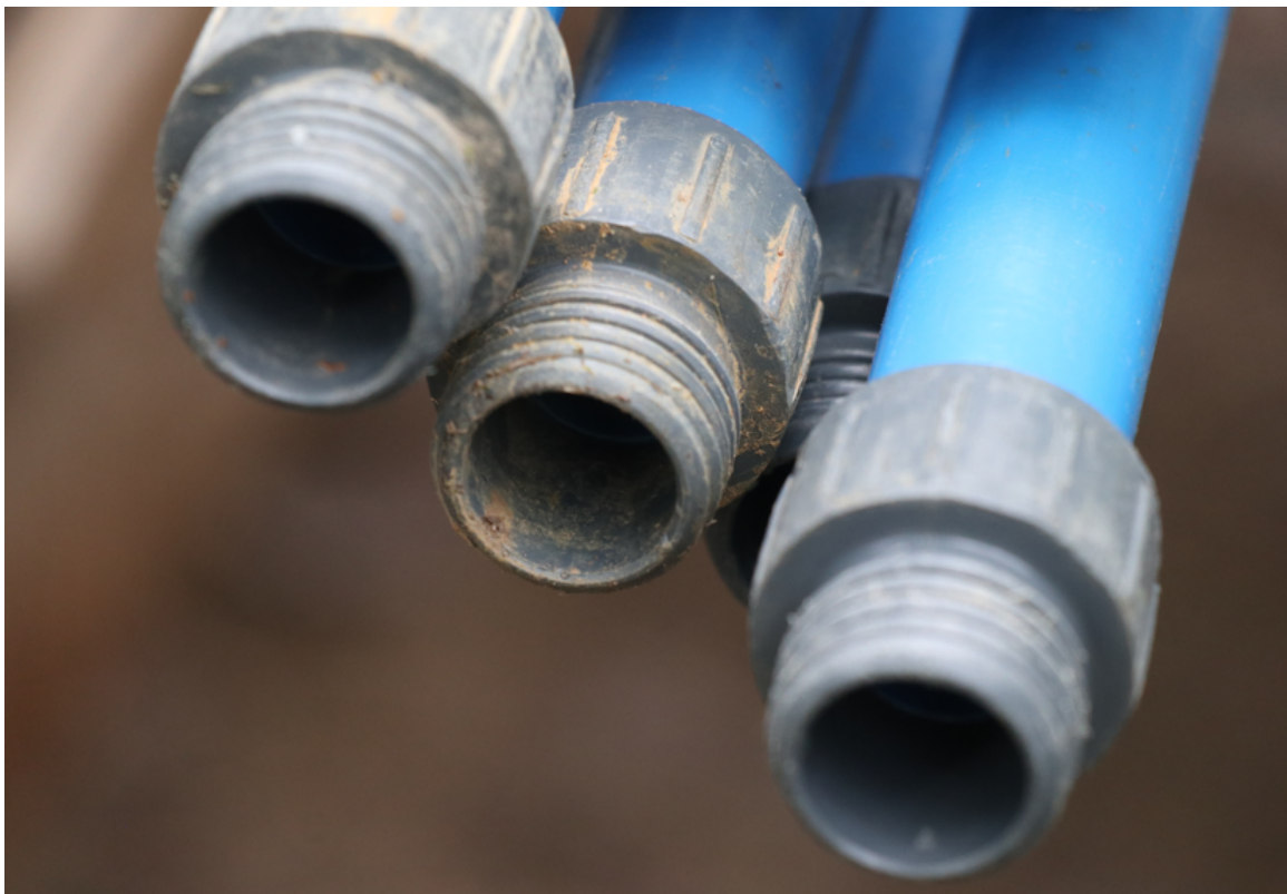
Abb. 8: Fotobeispiel zur Kategorie „Verschmutzungen“ – verschmutzte Steigrohre
