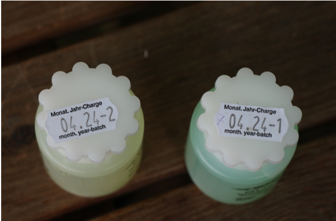
Abb. 12: Fotobeispiel Kategorie „Kalibrier- und Rückführfehler“ – abgelaufene Standards
