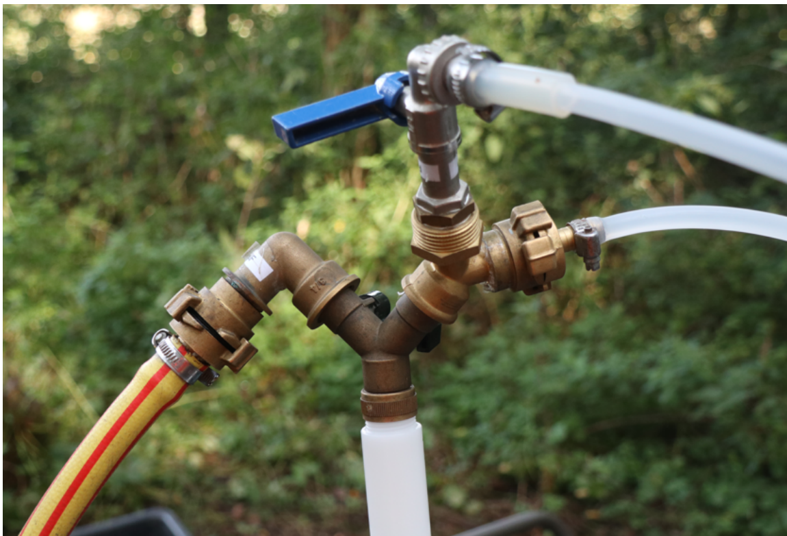
Abb. 10: Fotobeispiel zur Kategorie „falsche Werkstoffe am Probenahmesystem“ – Messingteile vor dem Probenahme-Abzweig
