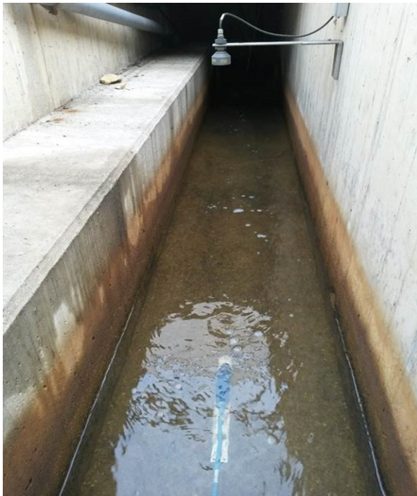
Abb. 10: Beispiel Ultraschall-Dopplerverfahren in einem Gerinne
