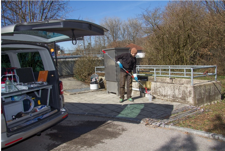
Abb. 14: Probenahme durch Privaten Sachverständigen der Wasserwirtschaft (PSW)
