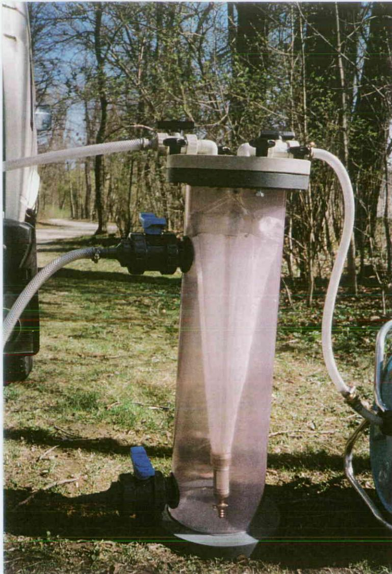
Abbildung 14 : Probennahmekammer mit Planktonnetz
