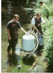
Abb. 4: Sedimentstechrohr, aufgesetzt auf Schieber zur Abmessung der obersten 15 cm (links) und Freeze-Corer im Einsatz (rechts)
