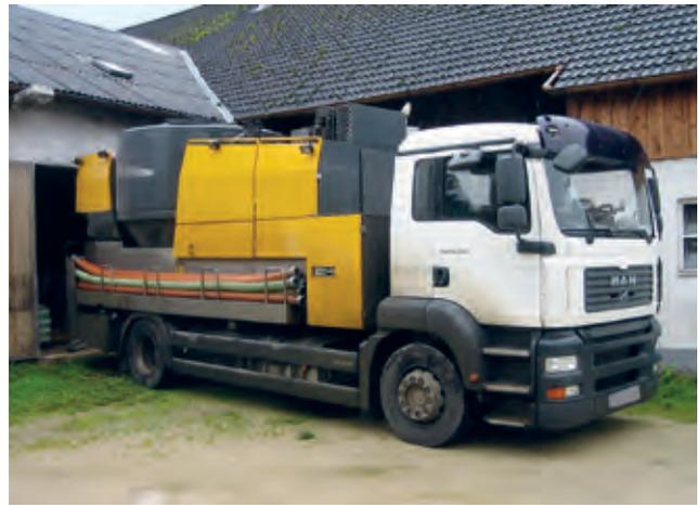
Abbildung 21: Fahrbare Mahl- und Mischanlage
