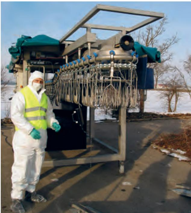
Abbildung 2: Mobile Elektrotötungsanlage
