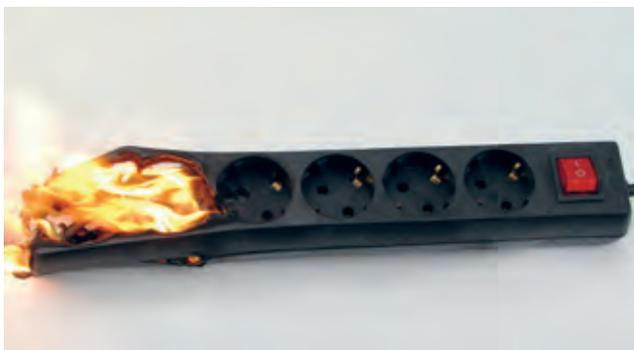
Abbildung 16: Viele Alltagsgegenstände, so auch die Steckerleiste bei diesem Brandversuch, sind mit Flammenschutzmitteln ausgerüstet, welche die Ausbreitung von Bränden hemmen sollen.
