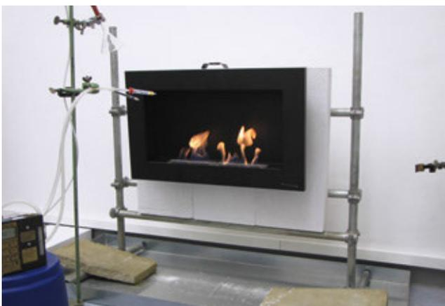
Abbildung 5: Testaufbau für Ethanolöfen
