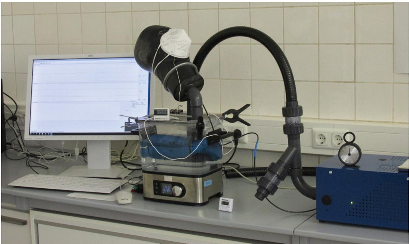
Prüfstand zur Gebrauchssimulation bei FFP-Masken
