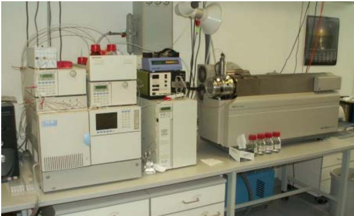
**Abbildung 4: LC-MS/MS-Gerät**
