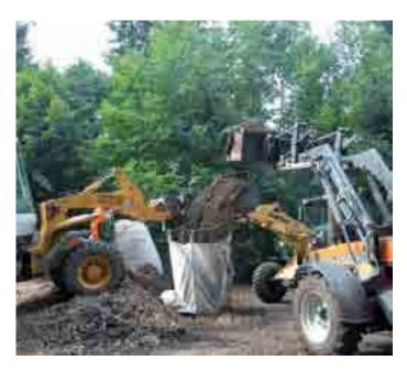
Beladen eines Transportbehälters: Eine Lademaschine hält den Transportsack geöffnet. Die Schlaufen des Sacks sind dabei auf die Zinken einer Ladegabel geschoben. Die andere Maschine füllt Hackschnitzel ein. Foto: Hartmut Strunz
