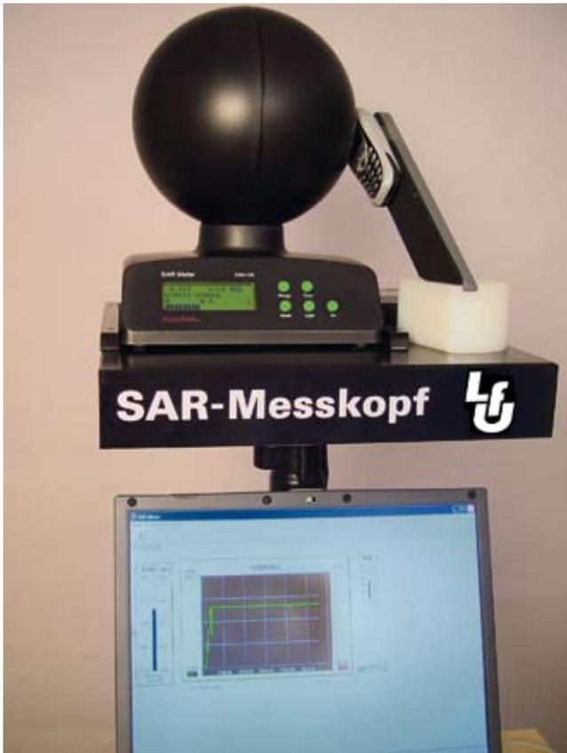
Dieses Wechselspiel zeigt folgender Messgang, bei dem mit einem Messkopf die Exposition am Kopf des Nutzers durch das Handy gemessen wird und gleichzeitig mit einem Personendosimeter die Exposition durch die Mobilfunkantenne. Es wird deutlich, dass mit der Entfernung von der Basisstation die Exposition durch das Handy stark ansteigt.
