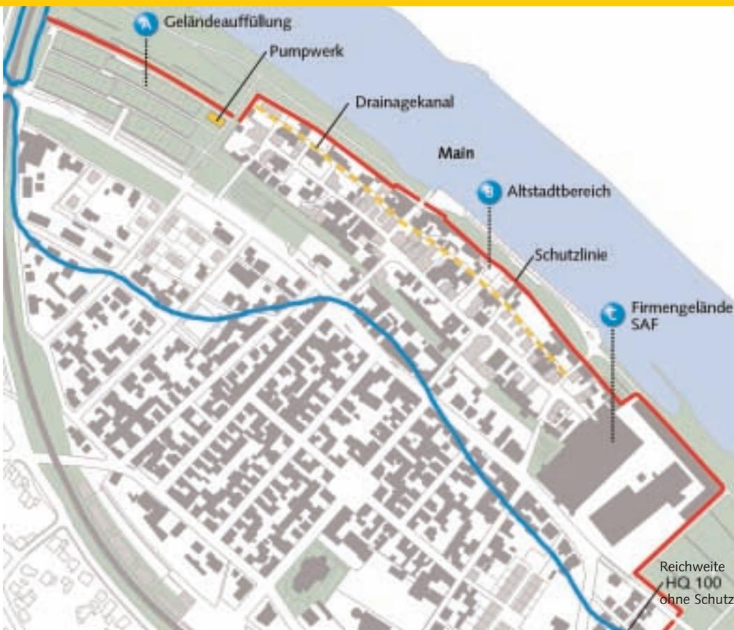
*Grafik:* Die Schutzwand gegen den Main gliedert sich in drei Abschnitte: Die Lücke zwischen einem bereits bestehenden Bahndamm und der Altstadt schließt eine 200 Meter lange Geländeauffüllung (A). Die Altstadt selbst wird durch eine Hochwasserwand geschützt, die dem Verlauf der historischen Stadtmauer folgt (B). Daran schließt eine Betonwand um ein Firmengelände an (C).
