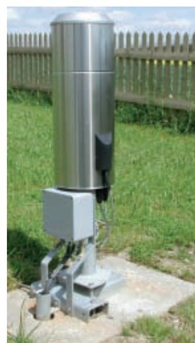
Bild unten: Automatische Niederschlagsmessstation (Ombrometer).
