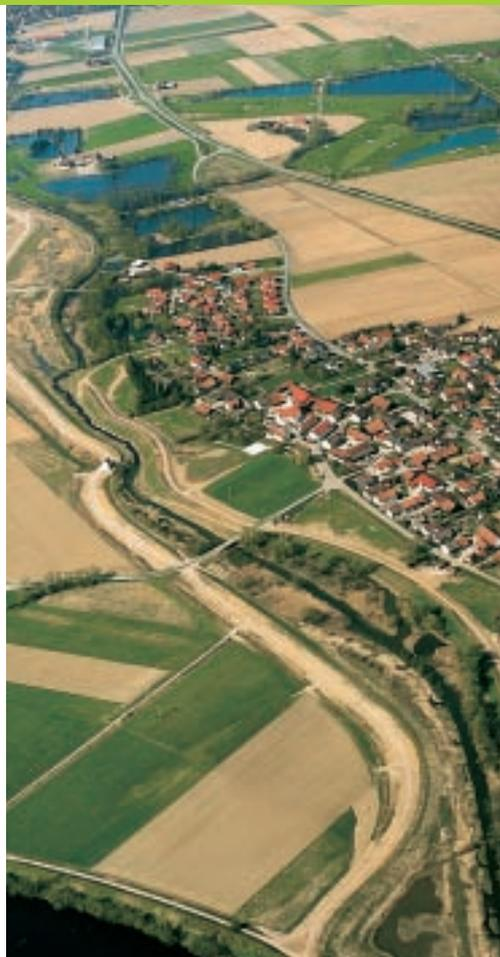
*Karte und Bild: Deichrückverlegung an der Kößnach. Die Abbildungen zeigen den zuletzt fertig gestellten Abschnitt zwischen der Brücke Pichsee und dem Anschluss an den alten Donaudeich.*
