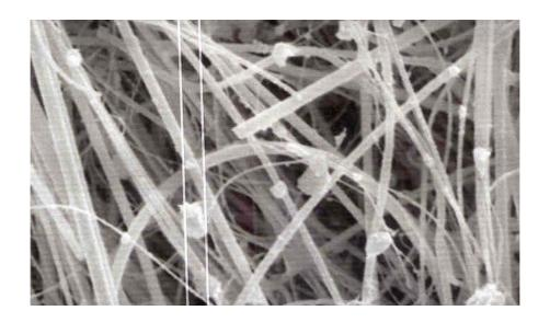
Abbildung 9: Rasterelektronische Aufnahme eines Glasfaserfilters (Partikel im Messfokus 18 µm)
