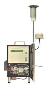
Abbildung 1: Low Volume Sampler LVS3 der Firma Leckel
