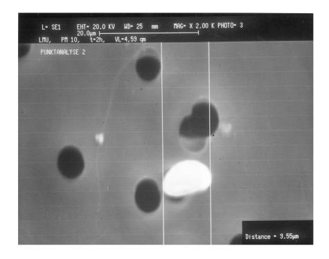
Abbildung 10: Rasterelektronische Aufnahme von PM-10-Staub (Partikel im Messfokus 9,5 µm)
