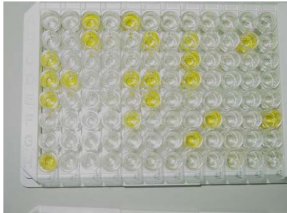
Abb. 12: Automatenystem für Untersuchungen zum Antikörpernachweis und Enzymimmunoassay: Testplatte mit positiven Ergebnissen (Farbumschlag nach gelb)
