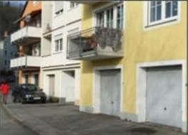
Abb. 2: Praxisbeispiel: Keine hochwasserempfindliche Nutzungen im Keller- oder Erdgeschoss, um Hochwasserschäden zu vermeiden und die Flutung im Extremfall zu lasten. Quelle: Wasserverschaffungsamt Deggendorf (Foto) im Internetangebot des ILU
