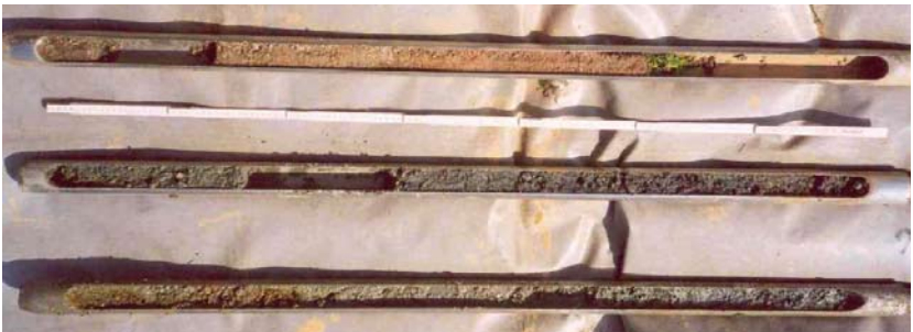
Abb. 19c: Sondierung Hungerberg (S 13) [45 96 910, H 54 16 720]; Die Sondierung erfolgte in den Dunklen Diatexit und erreichte eine Endteufe von 3,9 m. Es wurde zerrütteter (kataklastisch beanspruchter) blau-grauer Diatexit in Sand- bis Kiesgröße angetroffen. Unverwitterte, kantige Feldspat-Bruchstücke bis 2 cm Größe treten auf. Eine lehmige Komponente konnte festgestellt werden. Wasserzutritt fand ab 1,1 m Teufe statt.
