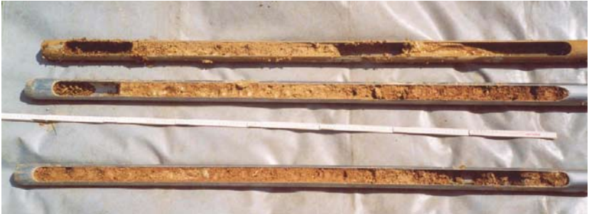
Abb. 19b: Sondierung im Gneiszersatz Oberöd (S 21) [45 94 160, H 54 11 390]; Die Endteufe dieser Sondierung lag bei 6,0 m. Es wurde sandiger, teils sandig-lehmiger brauner Biotit-Plagioklas-Gneis-Zersatz angetroffen. Die enthaltenen Biotitplättchen waren messingfarben alteriert, aber nicht weiter zersetzt. Von einer geringfügigen Umlagerung des Lockermaterials in den oberen Metern kann ausgegangen werden. Zum Wasserzutritt kam es bei einer Teufe von 2,7 m.
